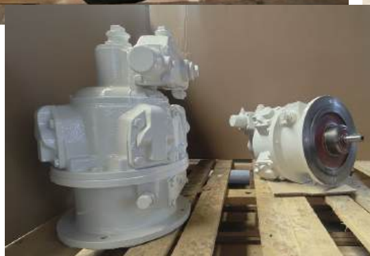
3- camadas de pintura epoxy.
